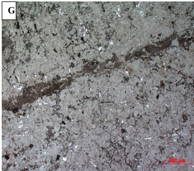
Veine de dolomite (Dol) recoupant la matrice, LPNA (G), LPA (H) de l'échantillon 04061481
