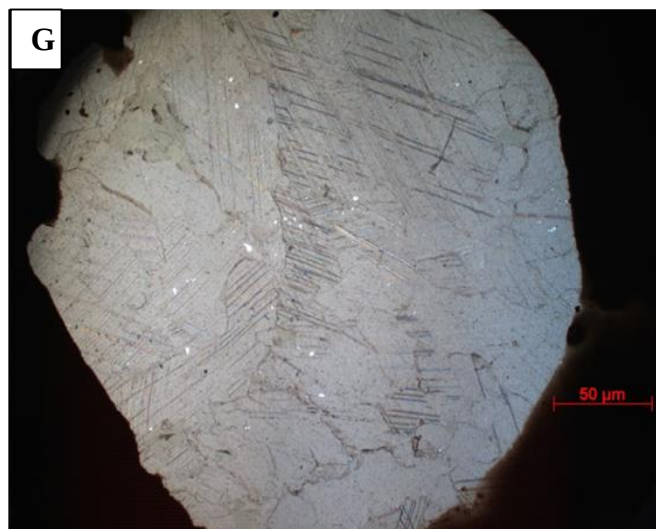
Schistosité contournant un porphyroblaste de tourmaline (Tur), LPNA (E), LPA (F) ; veine de calcite (Cal) avec chlorite (Chl), LPNA (G), LPA (H) de l'échantillon KDH291.562-2
